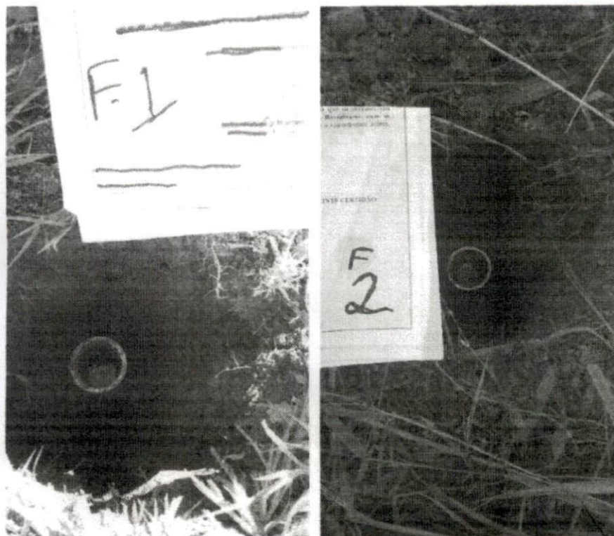
Figura 1- Ensaio de permeabilidade no Solo.
